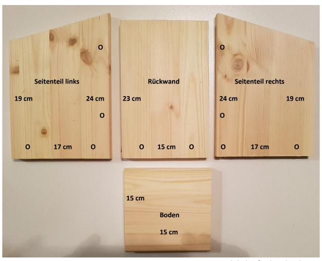
**O** = 10 Bohrlöcher für die Schrauben
